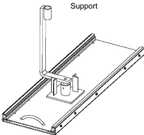
1. Positionner la vanne. (Regardez à page derrière). Poignée accessible bien. Hauteur 1.7m du sol. Respecter, le tuyau intermédiaire. Contrôler l'utilisation.
