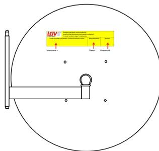
1. Positionner l'armoire. Le support du dévidoir doit être du côté de la conduite d'alimentation (vanne).
