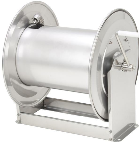
Manueller Schlauchaufroller aus Niro-Chromstahl V2a mit Handkurbel zum Aufrollen des Schlauches, mechanische Bremse bzw. Arretierung. Mit EPDM-Schlauch, abriebfesten Schlauch oder Lebensmittelschlauch mit Innendurchmesser 19mm oder 25mm. Schlauchlängen 20m, 30m, oder 40m (auf Anfrage auch andere Längen). Strahlrohr oder Waschpistole gummiert. ca. 2m Verbindungsschlauch.
