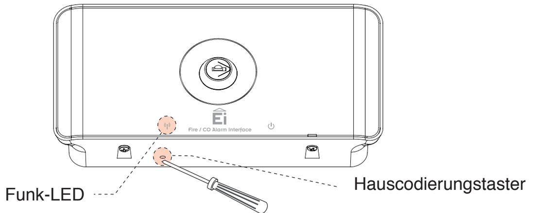
Schieben Sie einen dünnen Schraubenzieher durch die Öffnung und betätigen Sie den Hauscodierungstaster. Halten Sie ihn gedrückt bis die blaue Funk-LED leuchtet. Lassen Sie danach los.
