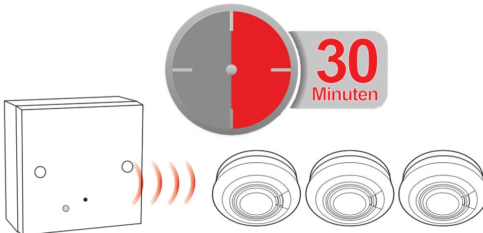
Ab jetzt steht ein Zeitfenster von 30 Minuten für die Vernetzung des Verbindungsmoduls mit den anderen Komponenten des Funksystems zur Verfügung.
