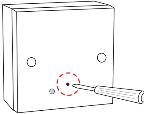
Den Hauscodierungstaster bei anliegender Versorgungsspannung durch das kleine Loch im Gehäuse drücken, bis die blaue LED aufleuchtet. Anschließend loslassen.
