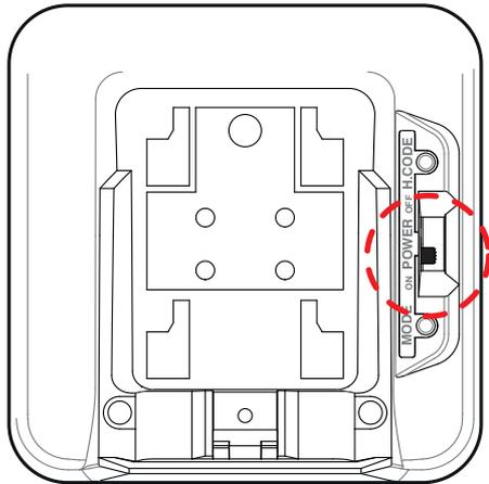
Einschalten des Alarmcontrollers durch Schieben des Schalters auf der Rückseite in „ON“-Stellung.
