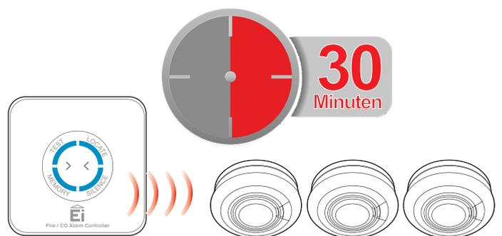
Ab jetzt steht ein Zeitfenster von 30 Minuten für die Vernetzung des Alarm-Controllers mit den anderen Komponenten des Funksystems zur Verfügung.
