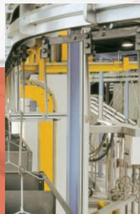
Einlauf von Werkstücken in eine Pulverbeschichtungskabine
